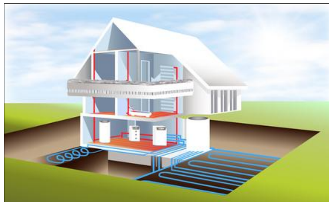
Bild 3: Kreislauf in neuem Wohnhaus mit Wärme aus dem Erdreich. © Foto: vector/ AngelaStolle - Fotolia.com
