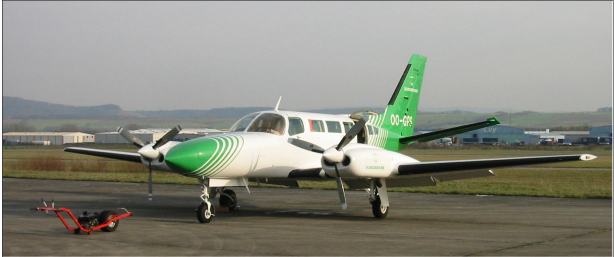
Bild 3: Das zur Thermografiebefliegung verwendete Flugzeug vom Typ Cessna 404, ist mit einer Thermalkamera vom Typ FLIR-CREDIP SILVER 660M ausgestattet. © Foto: Stadt Rheinbach
