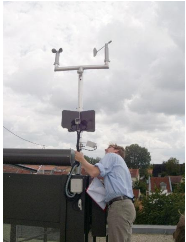
Bild 9: Ein Mitarbeiter des ZAE Bayern bei der Inspektion der Wetterstation auf dem Dach des Gebäudes. Insgesamt wurden über 850 Datenpunkte verifiziert und im Minutentakt jahrelang aufgezeichnet.
