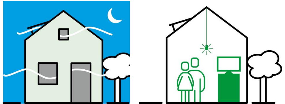
Abb. 6: Nachts sollten gegenüberliegende Fenster geöffnet und durch Querlüften die Innenräume abgekühlt werden. Auch hilft es, die internen Wärmelasten - Geräte, Beleuchtung - zu reduzieren.
