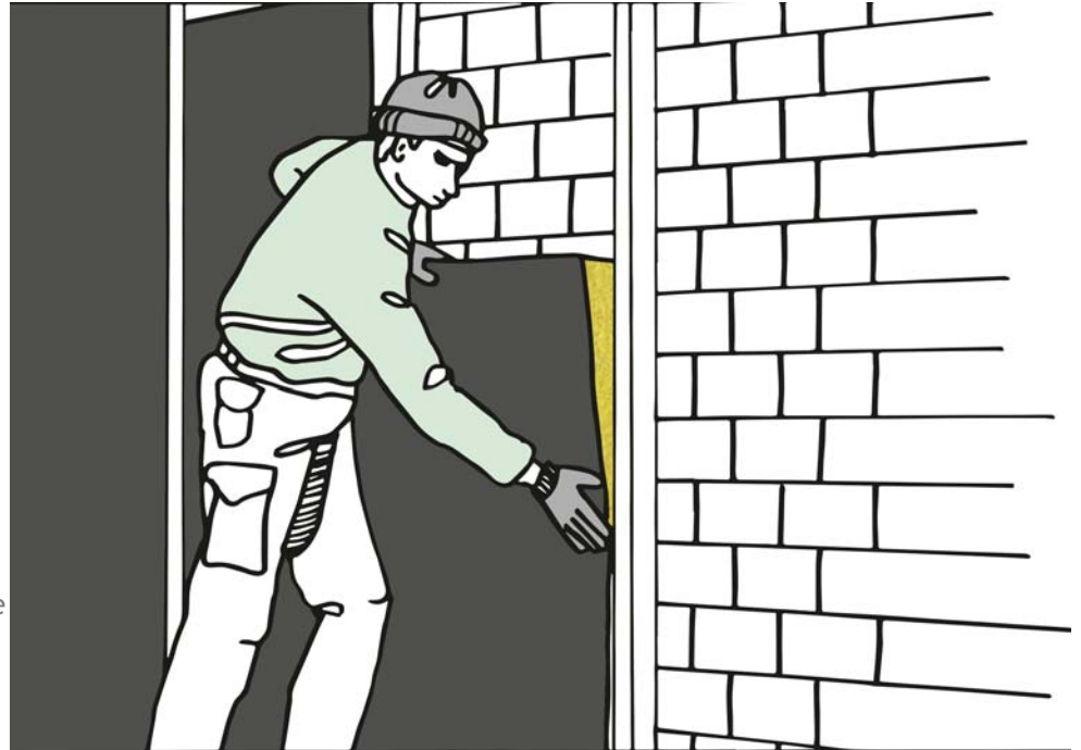
Bild 2: Mineralwolle sorgt für eine schnelle und leichte Verarbeitbarkeit bei der Fassadendämmung.
