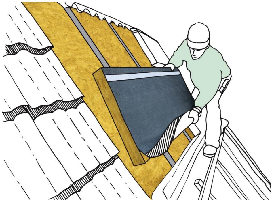
Bild 2: Bei einer Aufsparrendämmung wird Mineralwolle (Steinwolle oder Glaswolle) durch einen Fachmann auf dem Dach angebracht.
